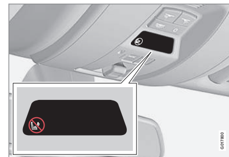
Indicação que mostra que o airbag do lado do passageiro está activado.
