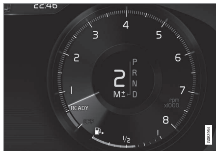
manualny tryb zmiany biegów na wyświetlaczu kierowcy 2 .
