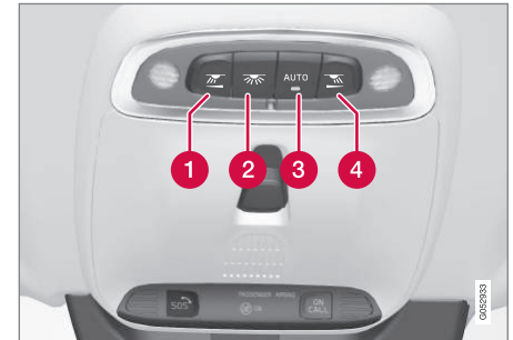
Commandes au plafond pour les liseuses avant et l'éclairage d'habitacle.
