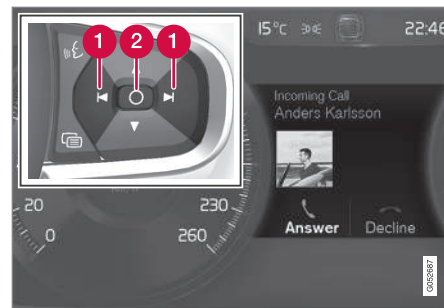
Messages sur l'écran conducteur 5 et commandes au volant droites.
