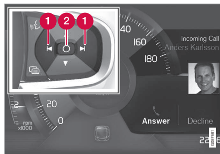
Messages sur l'écran conducteur 4 et commandes au volant droites.
