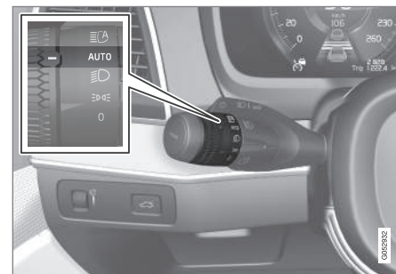
Levier au volant avec molette.
