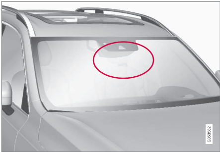
La zone indiquée ne doit pas être couverte (ni autocollant, ni aucun autre objet, etc.).
