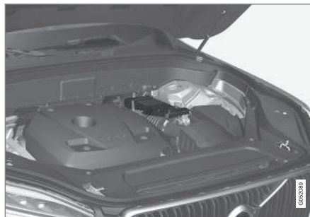
La batterie d'appoint est placée dans un boîtier près de la tourelle de jambe de force à ressort.
