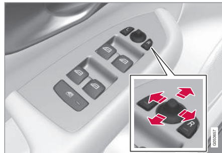
Przełączniki sterujące zewnętrznymi lusterkami wstecznymi.
