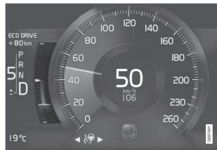
Wskaźnik ECO na 8-calowym wyświetlaczu kierowcy.
