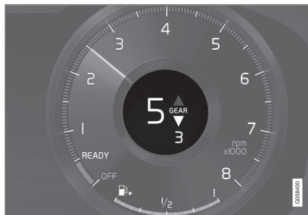
Wskaźnik zmiany biegu na 12-calowym wyświetlaczu kierowcy.
