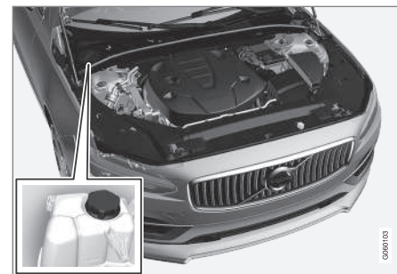
Zbiornik wyrównawczy płynu chłodzącego, samochód z kierownicą po lewej stronie.
