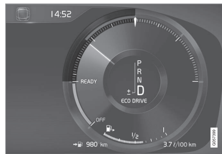
Wskaźnik ECO na 12-calowym wyświetlaczu kierowcy.
