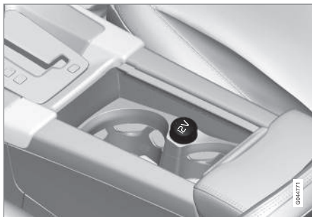
12 V-uttak i tunnelkonsoll, forsete.
