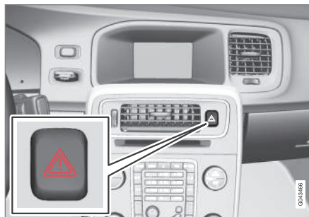
Knapp for varselblinklys.
