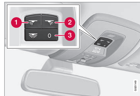
Reguleringsbrytere i takkonsollen for fremre leselamper og kupébelysning.
