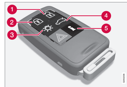
Nøkkelens knapper for fjernstart.
