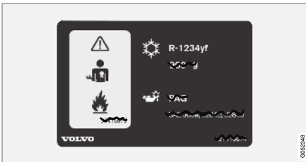
2 Aufkleber für Klimaanlage mit Kältemittel R1234yf.
