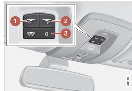
Interrupteurs d'éclairage, éclairage de pavillon avant
