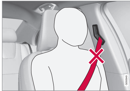
Cintura di sicurezza posizionata in modo errato. La cintura deve aderire alla spalla.
