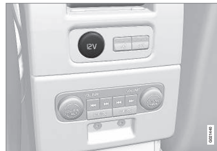
Preso da 12 V nel tunnel, sedile posteriore.
