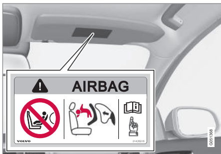
Opzione 1: Etichetta dell'airbag sull'aletta parasole lato passeggero.
