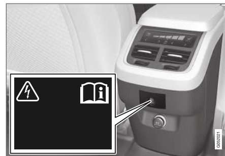
Presad alta tensione nel tunnel, seconda fila di sedili.
