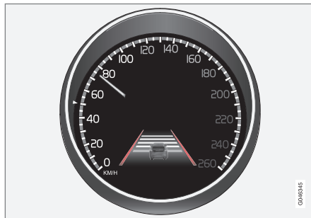
Linhas laterais da função LDW (marcadas a vermelho na imagem).
