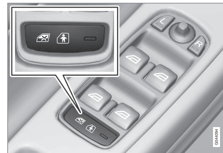
Painel de comando da porta do condutor.
