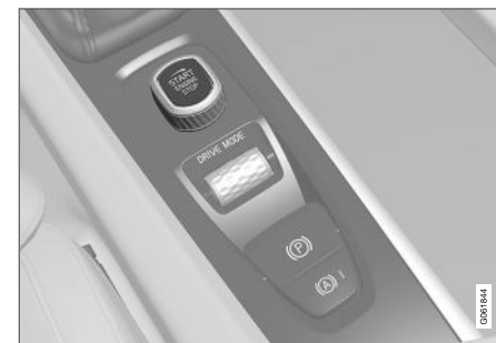
Startknappen i tunnelkonsollen.
