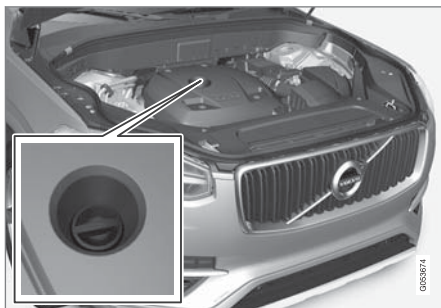
ทอเติมน้ำมัน 12
