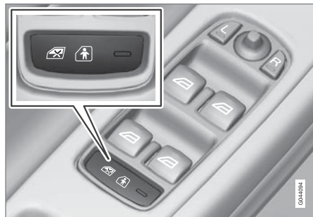
運転席ドアのコントロールパネル
