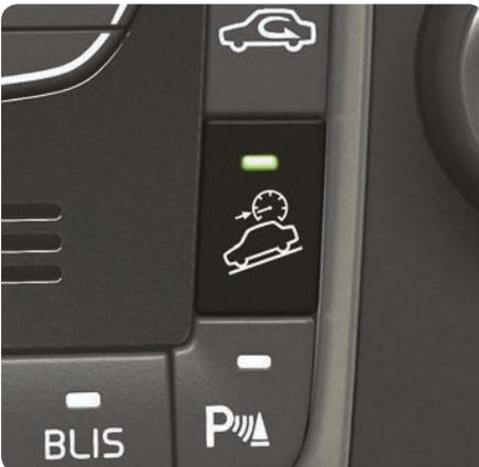
Le Hill Descent Control (HDC) permet d'augmenter/ réduire la vitesse dans les fortes pentes en utilisant uniquement la pédale d'accélérateur afin que le conducteur puisse se concentrer sur la direction.
