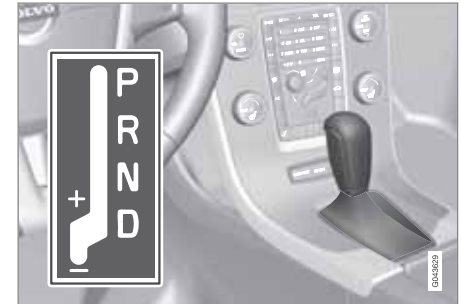
D: automatisch schakelen. + (-): handmatig schakelen.
