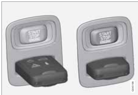
Contactslot met transpondersleutel uitgetrokken/ingeduwd en knop START/STOP ENGINE .
