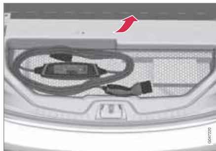
De laadkabel zit in de opbergruimte onder de laadvloer in de bagageruimte.
