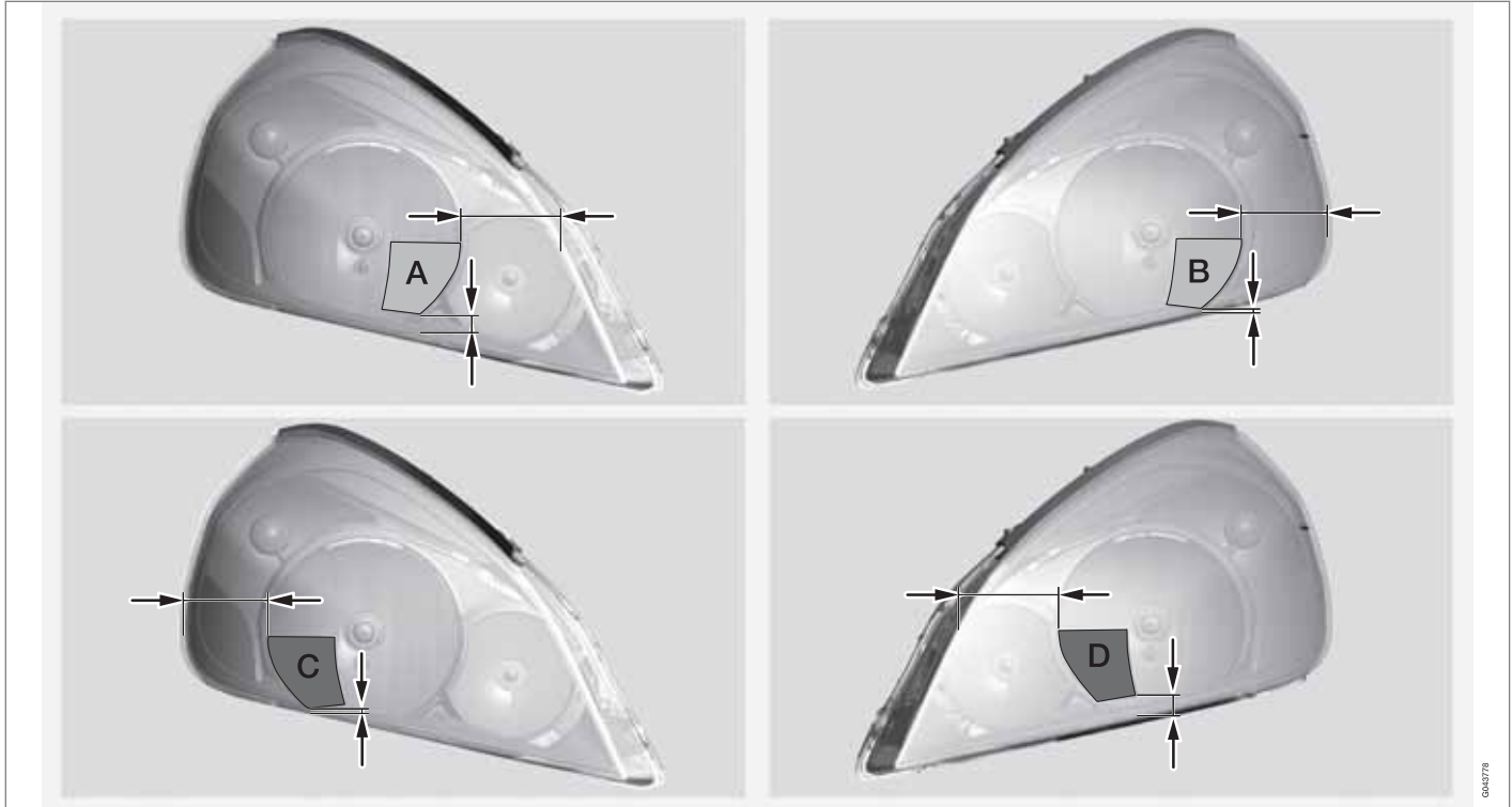
Bovenste regel: auto met stuur links, mallen A en B. Onderste regel: auto met stuur rechts, mallen C en D.
