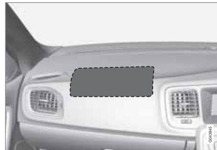
Positie van de passagiersairbag in een auto met het stuur rechts.
