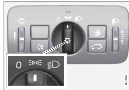
Verlichtingsdraaiknop in stand voor stads-/parkeerlichten vóór en achterlichten.
