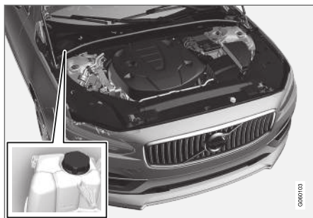
Jäähdytysjärjestelmän paisuntasäiliö, vasemmalta ohjattava auto.
