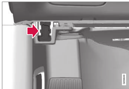
Diagnosiulosotto (On-board Diagnostic -liitäntä, OBDII) kojelaudan alla kuljettajan puolella.
