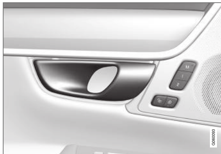
Avauskahva vaihtoehtoista sivuoven lukituksen avaamista varten.
