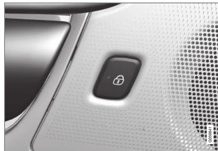
Lukitsemisen painike ja merkkivalo takaovessa.
