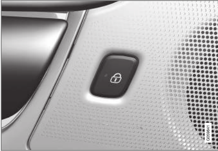
Låsknapp med indikeringslampa i baddörr.
