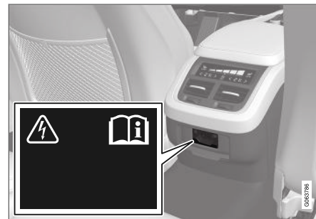
Eluttag i tunnelkonsol, baksäte.
