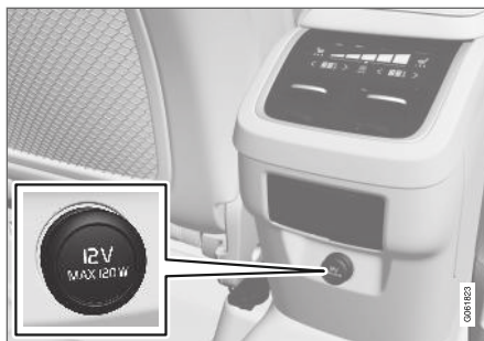
12 V-eluttag i tunnelkonsol, baksäte.
