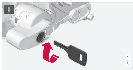
1 Sätt i nyckeln och vrid den medurs till upplåst läge.
