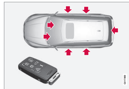
Låspunkter för fjärrnyckel med nyckelblad.
