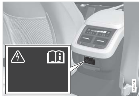
뒷좌석 터널 콘솔의 전원 소켓.
