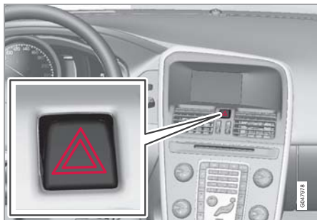
非常点滅灯ボタン
