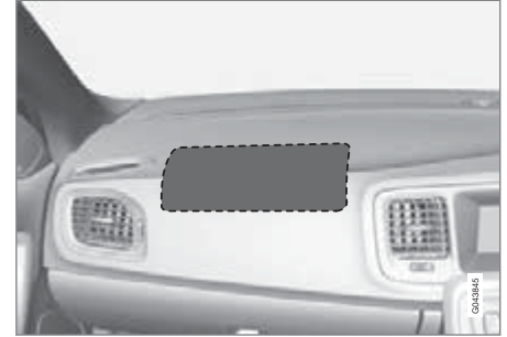
ตำแหน่งของถุงลมนิรภัยผู้โดยสารด้านหน้าในรถพวงมาลัยขวา
