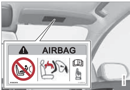
ตำแหน่งที่ 1: ตำแหน่งของป้ายถุงลมนิรภัยบนที่นั่งแถวคนโดยสาร
