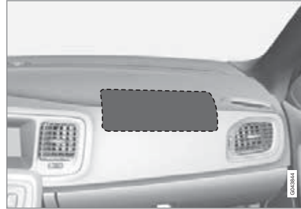
ตำแหน่งของถุงลมนิรภัยผู้โดยสารด้านหน้าในรถพวงมาลัยซ้าย
