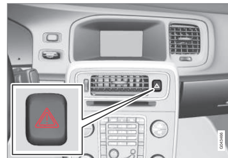
Кнопка аварійної сигналізації.
