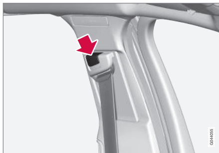
Регулювання висоти ременя безпеки. Натисніть кнопку та відрегулюйте верхнє кріплення у вертикальній площині. Розташуйте верхнє кріплення якомога вище, але щоб при цьому ремінь не терся вам по шії.
