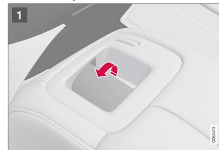
Em veículos com rebatimento do apoio de cabeça controlado eletronicamente\*, os apoios de cabeça laterais podem ser descidos utilizando a alça no lado superior do banco, consulte a figura **1**. Observe que esse método também rebate os encostos. Se somente os apoios de cabeça devem ser rebatidos, por exemplo, para melhorar a visibilidade, isso pode ser feito no visor central\*.
