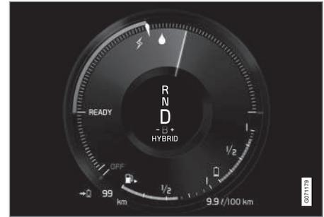
Visor do motorista em condução tanto com o motor elétrico como com o motor a combustão interna.
