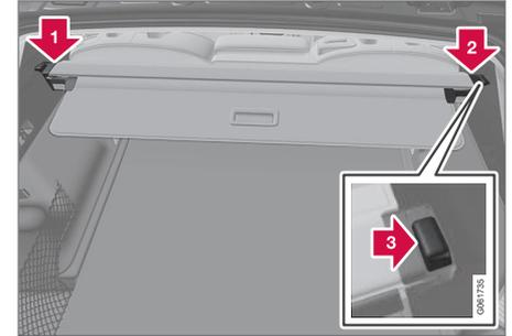
1. Insira uma extremidade da tampa da carga na ranhura do painel lateral na área de carga.
