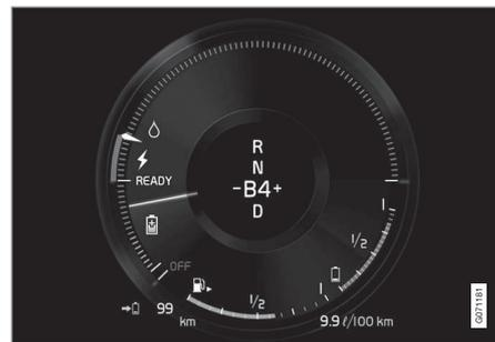
O veículo gera corrente para a bateria, a bateria é carregada com, por exemplo, ligeira pressão no pedal do freio ou frenagem com o motor em uma descida.
