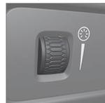
Com o seletor rotativo no painel de instrumentos, à esquerda do volante, ajusta-se a intensidade da luz da iluminação do visor, a iluminação dos controles a luz ambiente e a iluminação
