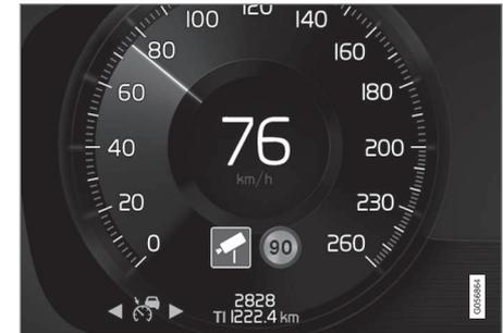
Exemplos de informação sobre radares fixos de velocidade e limite de velocidade no visor do motorista.
