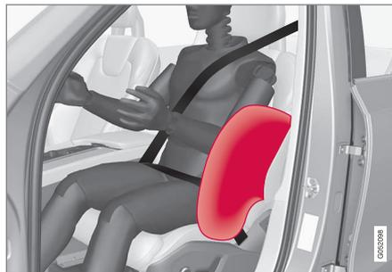
Os airbags laterais são instalados nas estruturas externas do encosto nos bancos dianteiros para ajudar a proteger o motorista e o passageiro dianteiro.
