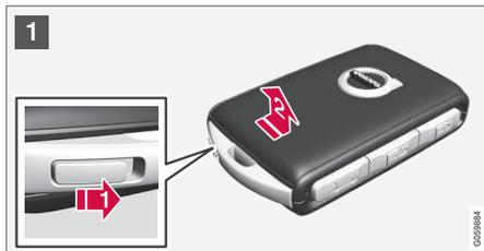
1 **1** Segure a chave do controle remoto com a frente visível e a logo Volvo para o lado direito. Deslize o botão na extremidade de baixo do anel da chave para a direita. Deslize a proteção lateral dianteira alguns milímetros para cima.
