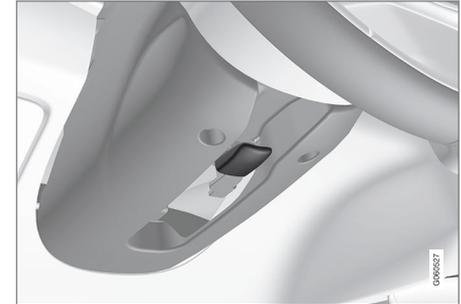
Alavanca para ajuste do volante.
