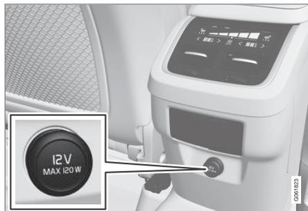
Tomada elétrica 12 V no console de túnel, banco traseiro.
