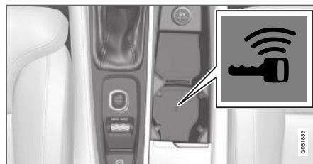
Backup-læserens placering i tunnelkonsollen.
