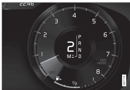
대형 기어 셀렉터가 장착된 차량의 수동 변속 모드에서 스티어링휠 패들을 이용해 기어를 변경할 때의 운전자 화면.
