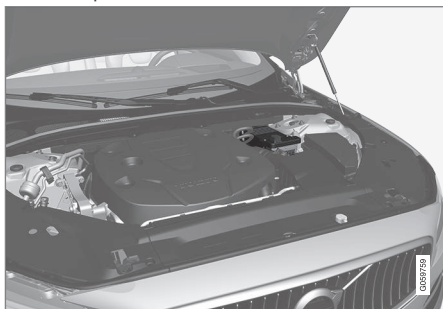
Støttebatteriet på 12 V er placeret i en kasse ved siden af fjederbenstårnet.
