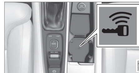
Varmistusringin sijainti tunnelikonsolissa.
