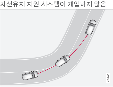
차선유지 지원 시스템은 도로 안쪽 방향의 급커브에서는 작동하지 않습니다.
