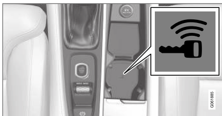
Backup-læserens placering i tunnelkonsollen.
