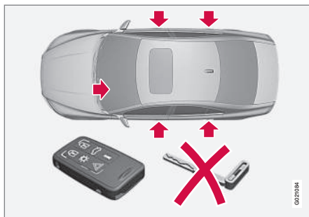
Punti di bloccaggio della chiave del telecomando senza stelo della chiave e con Private locking attivato .
