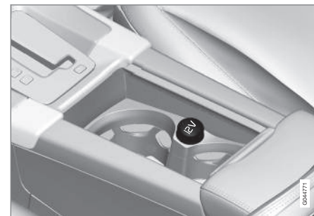
Preso da 12 V nel tunnel, sedile anteriore.
