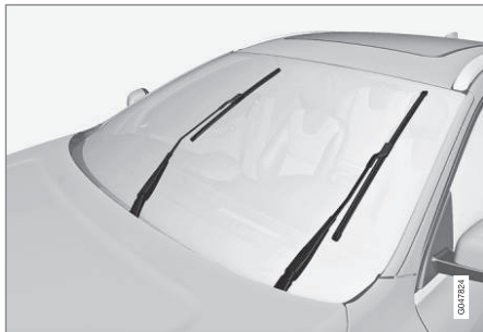
Spazzole tergicristallo in posizione di assistenza.
