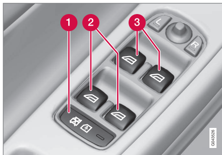
Reglagepanel i förardörr.
