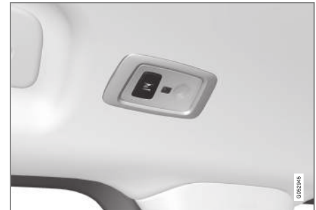
Los vehículos con techo panorámico* tienen dos unidades de luces, una a cada lado del techo.
