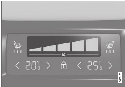
Control de ventilación en el panel de climatización de la consola del túnel.
