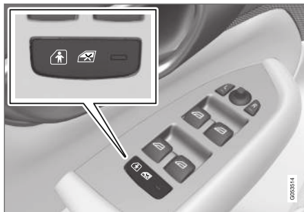
Botón de conexión y desconexión eléctrica.
