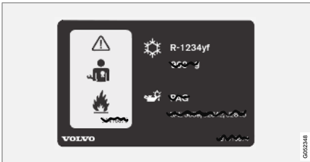
2 Külmutusainet R1234yf kasutava kliimasüsteemiga auto kleebis.
