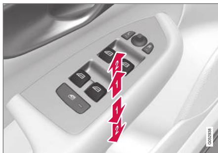
Aknatõstukite kasutamine.
