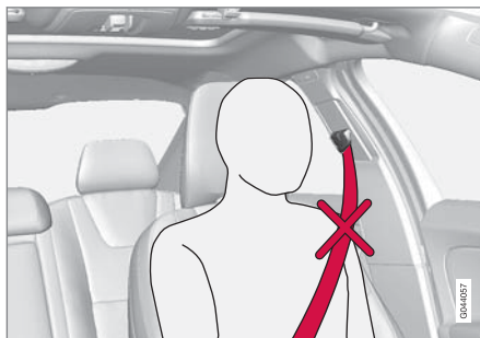
คาดเข็มขัดนิรภัยไม่ถูกต้อง เข็มขัดต้องทาบบู๊บนไหล่
