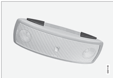
ไฟเพดานด้านหลัง
