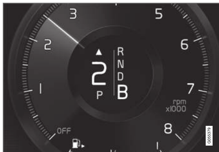
Indicatore di cambio marce nel display del conducente 3 .
