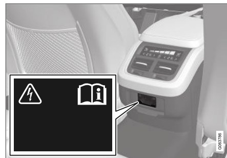
Presad alta tensione nel tunnel, sedile posteriore.
