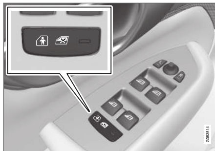
Pulsante di attivazione e disattivazione elettrica.
