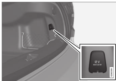
Presa elettrica da 12 V nel bagagliaio*.
