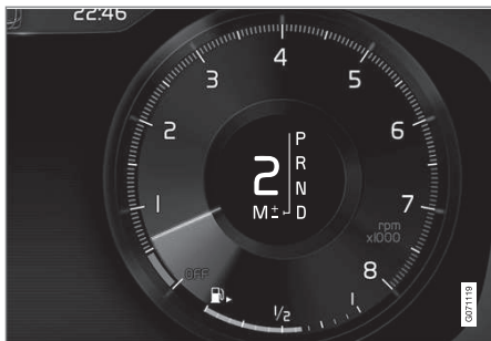
Vue d'ensemble de la grille de rapports dans l'écran du conducteur - avec grand levier de vitesses.
