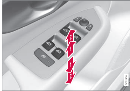
Fonctionnement des vitres électriques.
