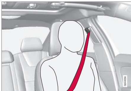
Ceinture de sécurité correctement placée.
