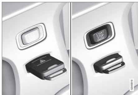
Contacteur d'allumage avec télécommande retirée/insérée.
