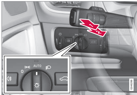
Lever au volant et bouton de commutateur d'éclairage.
