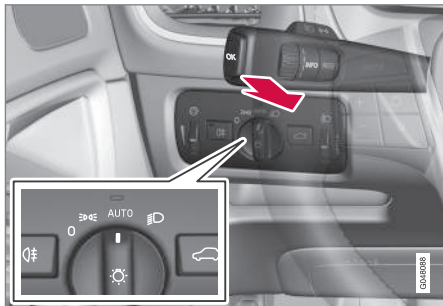
Levier au volant et bouton du commutateur d'éclairage en position AUTO .
