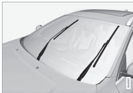
Balais d'essuie-glace en position d'entretien.
