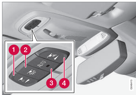
Commandes au plafond pour les liseuses avant et l'éclairage d'habitacle.
