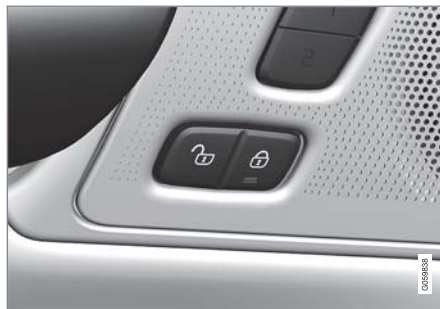
フロントドアのインジケータランプ付きロックおよびロック解除ボタン
