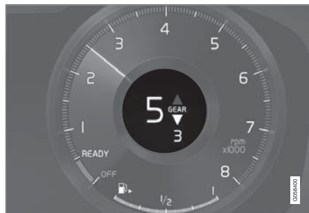
12 インチドライバーディスプレイ*のギヤシフトインジケータ
