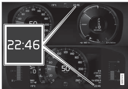
12 インチドライバーディスプレイと8 インチドライバーディスプレイの時計の位置
