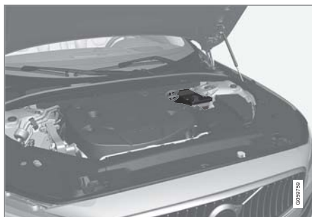
補助バッテリーはストラットタワーの横のボックス内にあります。
