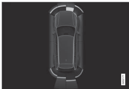
障害物ゾーンおよびセンサーセクターを示す画面表示
