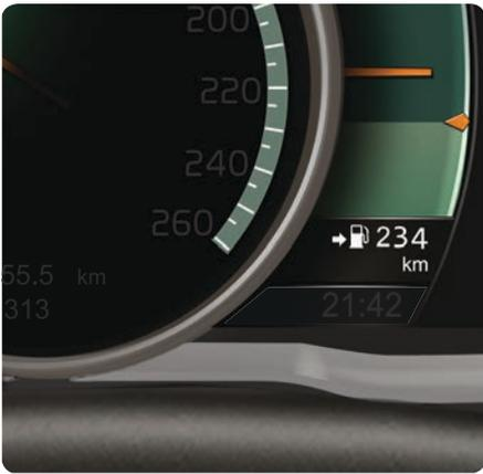
El cuadro de instrumentos muestra la autonomía estimada tomando como base anteriores condiciones de conducción y el combustible que queda en el depósito.
