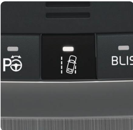
Si el automóvil está a punto de cruzar una línea lateral, el sistema LKA dirigirá activamente el automóvil de vuelta al carril aplicando al volante una ligera fuerza de giro. Si el automóvil traspasa una línea lateral, el sistema LKA avisará al conductor mediante vibraciones en el volante.
