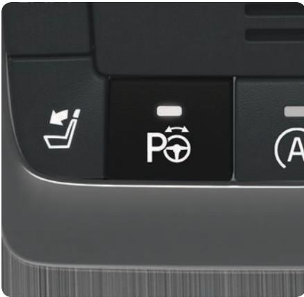
El sistema PAP controla el espacio disponible y realiza a continuación las maniobras con el volante. El conductor se encarga de seleccionar la marcha, regular la velocidad, frenar y parar el vehículo.
