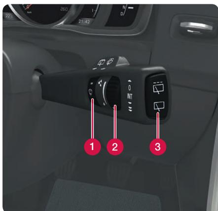
Portare la leva verso il basso per avviare i tergicristalli del parabrezza e verso l'altro per azionare un ciclo singolo dei tergicristalli.
