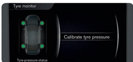
Dopo la sostituzione di pneumatici o modifica della pressione pneumatici è sempre necessario procedere alla taratura. Se si accende la spia (⚠), occorre controllare la pressione dei pneumatici e tarare il sistema. Procedere come segue:
