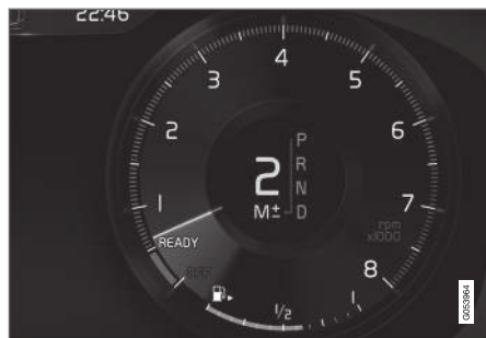
Manuel gearposition på førerdisplayet 3 .
