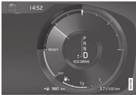
Eco-måleren på 12-tommer førerdisplay*.
