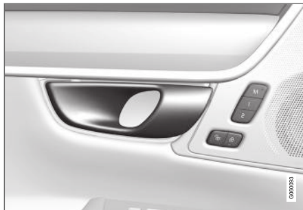
Åbningshåndtag til alternativ oplåsning i sidedør.
