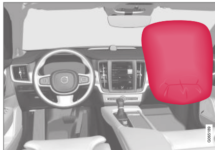
Airbag til forsædet i passagersiden
