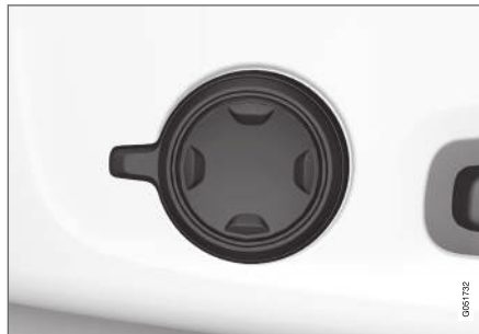
Multifunktionsknappen, placeret på siden af sædets sidedel.
