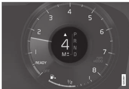
Gearskift-indikator på 12-tommer førerdisplay*.
