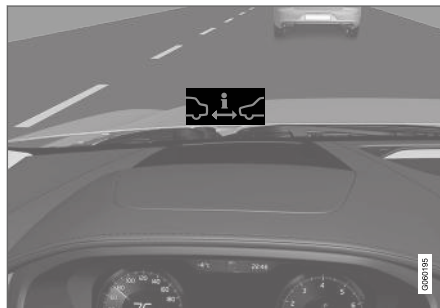
Symbol på forruden for afstandskontrol 36 .
