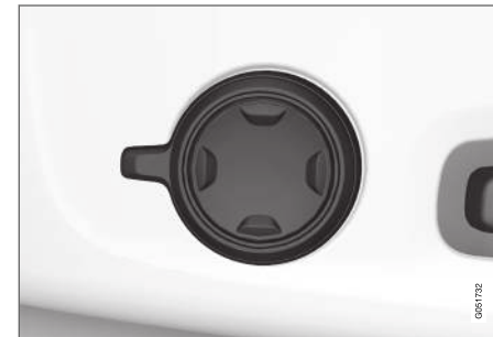
Multifunktionsknappen, placeret på siden af sædets side.
