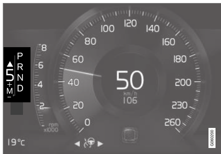
Gearskift-indikator på 8-tommer førerdisplay.
