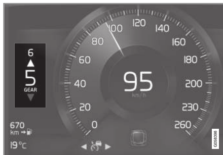
Gearskift-indikator på 8-tommer førerdisplay.
