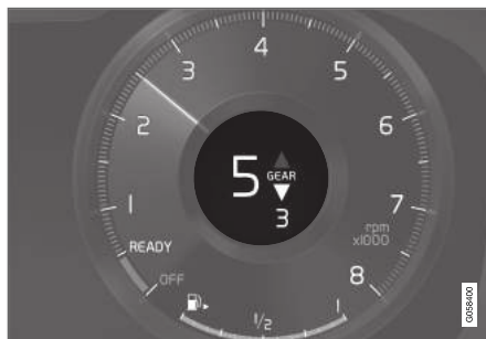
Gearskift-indikator på 12-tommer førerdisplay*.
