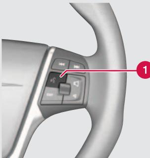
Die Sprachsteuerungsfunktion (nur in Fahrzeugen mit Navigationssystem als Sonderzubehör) kann verwendet werden, um bestimmte Funktionen des Navigationssystems und von Mobiltelefonen, die mit Bluetooth® angeschlossen sind, durch Sprachbefehle zu aktivieren.
