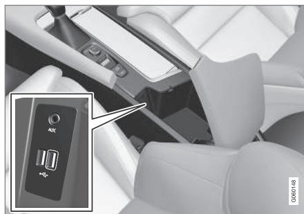
Port USB de la console de tunnel.
