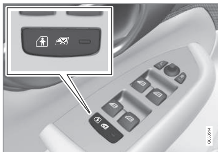
Bouton d'activation/désactivation électrique.
