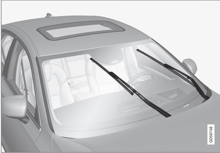
Balais d'essuie-glace en position d'entretien.
