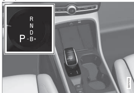
Oversigt over gearstang og gearskiftemønstre på førerdisplay
