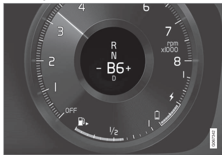
Oversigt over bremseposition på førerdisplay.
