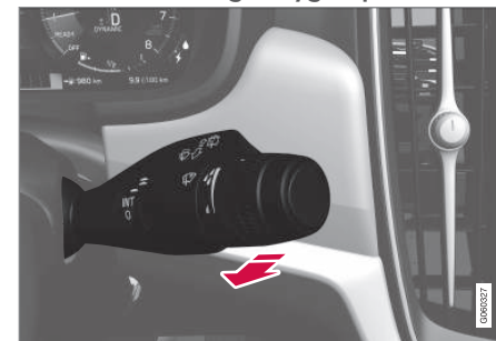
Sprinklerfunktion, højre kontaktarm.
