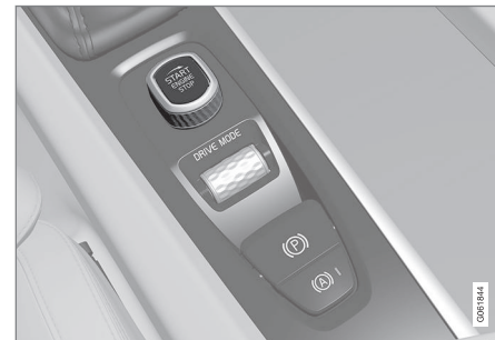
Startknappen i tunnelkonsollen.
