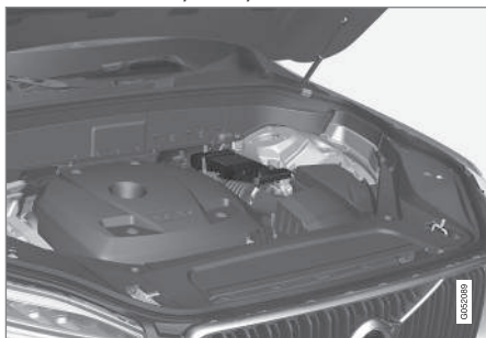
12 V:n apuakku sijaitsee laatikossa joustintukitornin vieressä.
