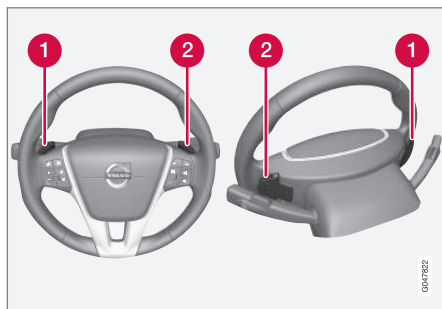
Palettes de changement de vitesses montées sur le volant
