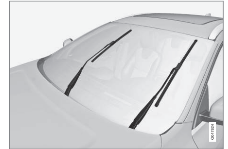
Balais d'essuie-glace en position d'entretien
