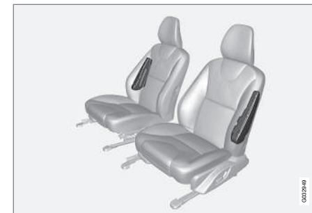
Emplacement des coussins gonflables contre les impacts latéraux (SIPS) (sièges avant seulement)
