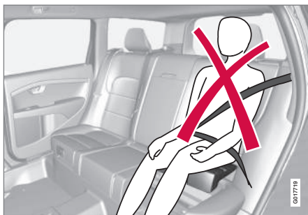
Position assise incorrecte : la tête de l'enfant dépasse l'appui-tête et le baudrier n'est pas placé en travers de la clavicule
