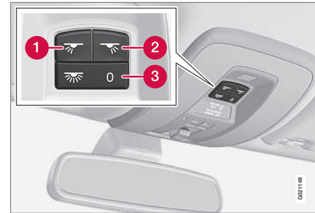
Interrupteurs d'éclairage, éclairage de pavillon avant
