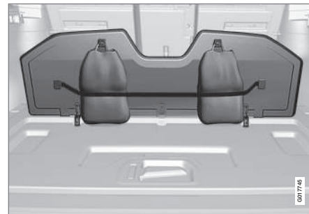
Dispositif d'arrimage des sacs d'épicerie sous le plancher de l'espace à bagages
