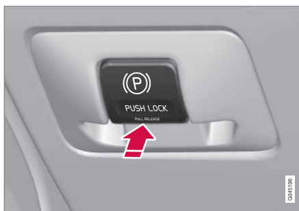
Елемент керування паркувальним гальмом - увімкнення.
