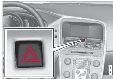
Кнопка аварійної сигналізації.
