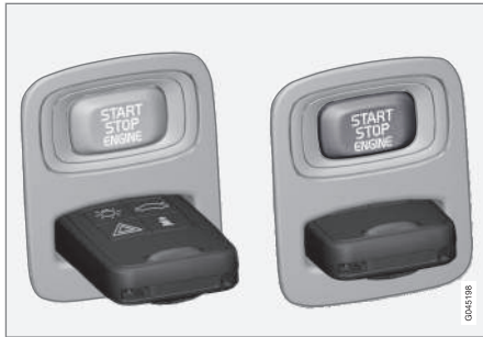
Вимикач запалення з витягненим/вставленим ключем ДК.
