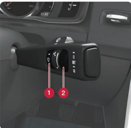
Desplace la palanca hacia abajo para activar los limpiaparabrisas y hacia arriba para realizar un barrido.
