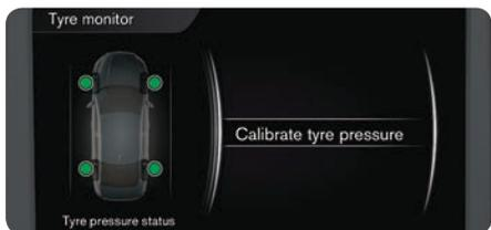
Después de cambiar los neumáticos o modificar la presión de neumáticos, debe realizarse siempre un calibrado. Cuando se encienden las luces (L), es necesario calibrar el sistema. Proceda de la siguiente manera:
