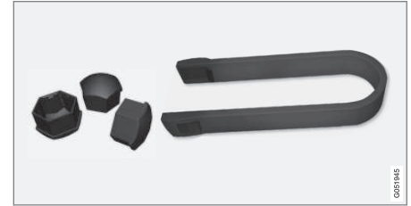
Tekerlek cıvataları üzerindeki plastik kapakları çıkartma aleti.
