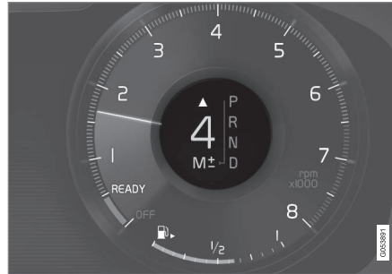
12 inç sürücü gösterge ekranındaki vites değiştirme göstergesi.
