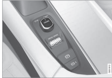
Tünel konsolundaki çalıştırma düğmesi.
